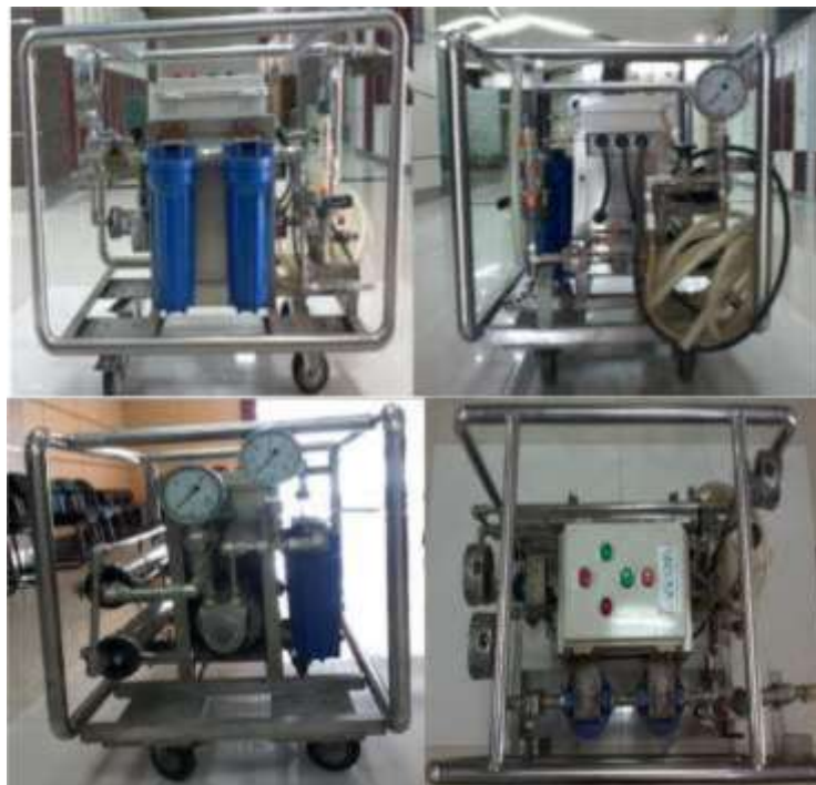
Gambar 2. Seperangkat alat RO yang digunakan dari beberapa sisi
