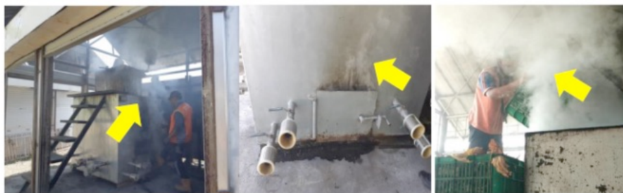
Gambar 11 Asap dari tungku pembakaran keluar dari celah-celah mesin L-Box (kiri-kanan: L-Box 07, L-Box 04)
