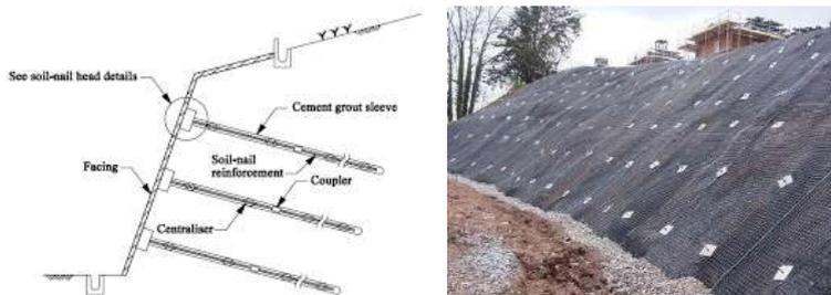
Gambar 6. Perkuatan Lereng dengan *Soil Nailing*
