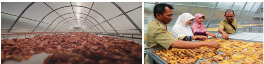
Gambar 1-12. Solar Dryer Dome Untuk Pengeringan Tomat di Thailand dan Pengeringan Pisang di Indonesia (Sumber: impack-pratama.com )
