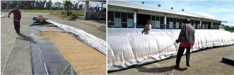
Gambar 1-15. Solar Bubble Dryer Untuk Pengeringan Gabah (Sumber: knowledgebank.irri.org)
